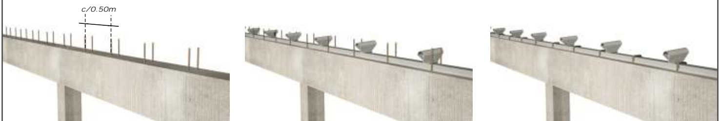
2) perfil portacaballetes con caballetes soldados posicionado entre los bigotes
